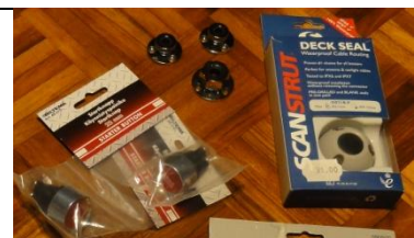
Kansiläpivientejä sähköjohdoille ja starttipainikkeet 2 kpl
